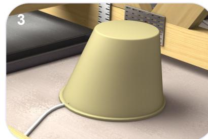
4. Souffler l'isolant sur le Capot de Spot jusqu'à ce que la hauteur requise soit atteinte.
